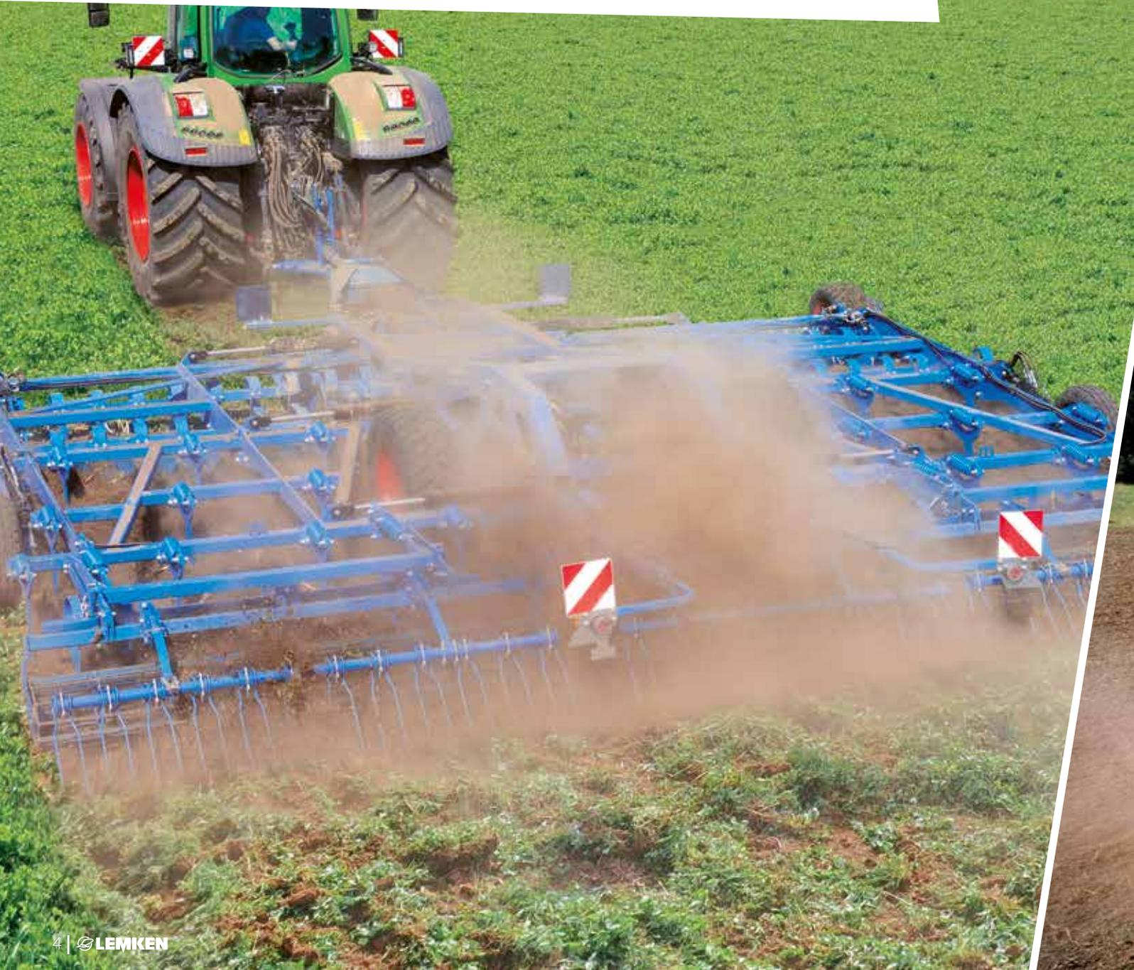
Direkt nach der Ernte müssen die Vorbereitungen für die optimale Entwicklung der Folgekultur geschaffen werden. Der **Koralin 9** schneidet die Stoppeln ganzflächig vertikal und horizontal, um den raschen mikrobiellen Abbau zu ermöglichen. Gleichzeitig mischt er die Ernterückstände sehr flach ein. Dadurch werden zum einen Unkrautsamen und Ausfallgetreide zum gleichmäßigen Auflaufen angeregt, zum anderen wird die Verdunstung verringert. Für die Folgefrüchte kann so Bodenwasser gespart werden.
