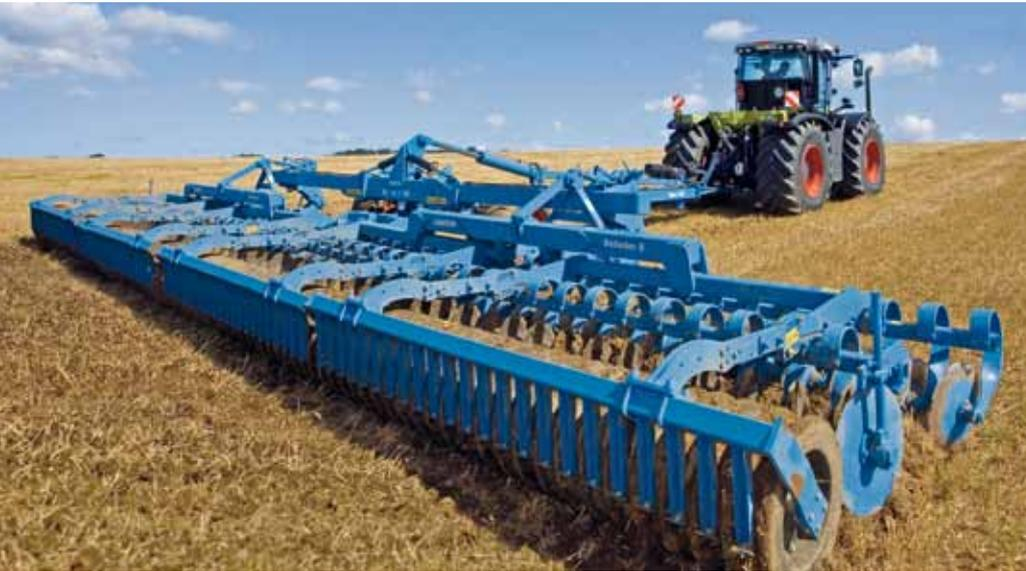
Das Konzept der Kurzscheibenegge Heliodor von LEMKEN beruht auf zwei Reihen einzeln an Blattfedern aufgehängten Scheiben. Damit ist eine gute Boden Anpassung garantiert und auch steinige Felder können störungsfrei bearbeitet werden. Die Scheiben sorgen bei der Stoppelbearbeitung für eine intensive Vermischung von Boden und Bewuchs.
